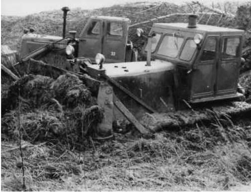
Abb. 92: Tagebau Zechau. Abgerutschte Planiererraupen nach Starkniederschlägen auf Mergel-, Tonböden der mittleren Kippenböschung, Juni 1979. Foto: W. Sykora
